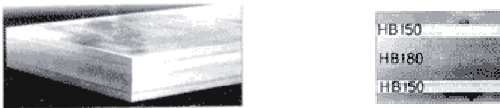
Rys. 6. Aluminiowa kompozycja ochronna Tristrato (z lewej) oraz twardość jej elementów składowych (z prawej) [6] Fig. 6. The aluminium protective composition Tristrato (on left) as well as hardness of its component (on right) [6]
